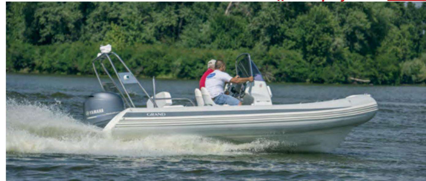
Скорость измеряли с помощью GPS, на борту были установлены цифровые тахометры, разгон (старт) начинали "с поджатым двигателем", а после выхода на глиссирование при помощи трима добивались максимальных показателей тахометров. Ветер и течение на акватории практически отсутствовали. На двигателях были стальные полированные винты, на Y-150 с шагом 21 дюйм, на Y-115 – 19 дюймов.
