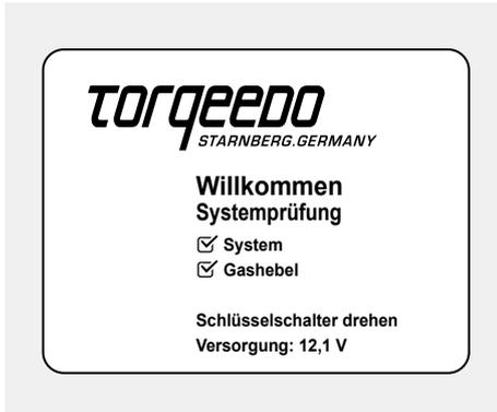
3. Drehen Sie den Schlüssel anschließend weiter in Position 3, um die Hochvolt-Batterien zu aktivieren.
