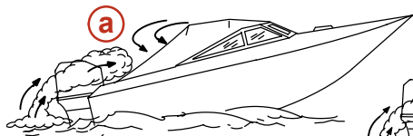
a- Эксплуатация катера со слишком высоким углом дифферента носа.
