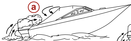
a - Эксплуатация катера со слишком большим углом носового дифферента.
