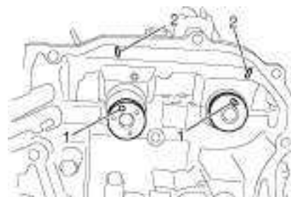
1. напр палец на распредвале 2. метки совмещения на корпусе распредвала
