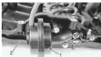
1. Камера разрежения 2. Впускной коллектор
