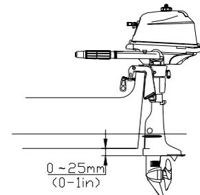
**ЗАМЕЧАНИЕ:** оптимальная высота крепления мотора зависит от комбинации лодки и мотора и предпочтений в эксплуатации. Испытания на различной высоте помогут определить оптимальную высоту установки. Для дальнейшей информации, консультируйтесь со своим дилером “PARSUN” или производителем лодки.
