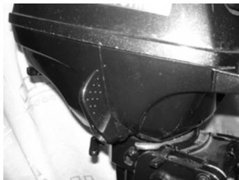
2. Максимально закрутите регулятор сопротивления повороту двигателя, чтобы избежать свободного вращения двигателя в поднятом положении
