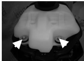
3. Снимая топливный бак, снимите болт с корпуса стартера.
