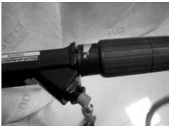
5. Если двигатель холодный, при пуске двигателя передвиньте рычаг обогащения смеси в закрытое (вытянутое или верхнее) положение. Сдвигайте его на половину вниз, пока двигатель прогревается. И полностью опустите (закройте) когда двигатель прогрелся.
