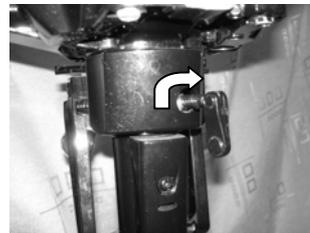
3. Закрутите воздушный винт на баке.
