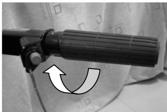
2. Быстро сдвиньте рычаг переключения передач и переведите его из нейтрального положения в положения хода вперед.
