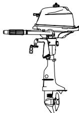
2. Подготовьте подходящий контейнер, который смог бы поместить в себя больше масла, чем оно содержится в двигателе. Открутите и уберите сливной винт, держа контейнер под отверстием слива масла. Затем снимите крышку масляного фильтра. Дайте возможность маслу полностью вытечь. И немедленно вытрите пролитое масло, если пролили.
