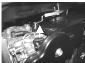
5. Снимите корпус стартера.
