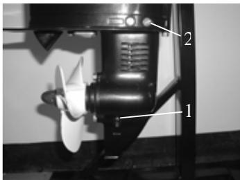
1. Винт сливного отверстия.
