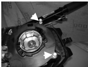
7. Установите 2 болта в тыловую часть топливного бака.
