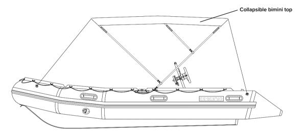
Fig. 25. Collapsible bimini top.
