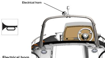
Fig. 24. Electrical horn.
