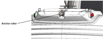
Fig. 38. Anchor roller.
