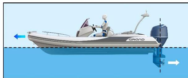
Рис. 19. Оптимальний кут нахилу двигуна.
