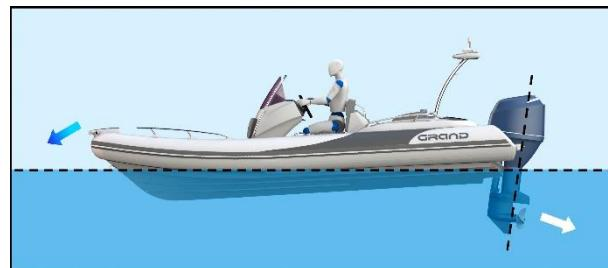
Рис. 21. Малий кут нахилу двигуна.
