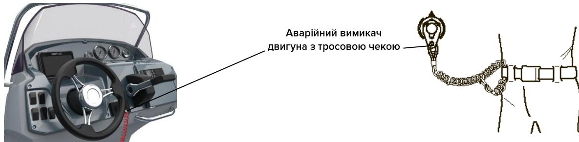
Рис. 23. Аварійний вимикач двигуна з тросовою чекою.
