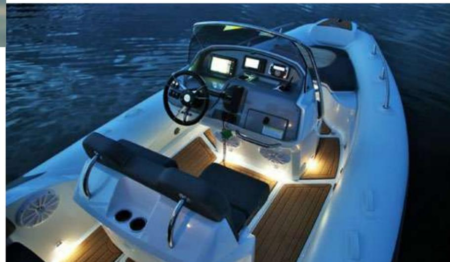
гармонійно. Помірно високий профіль тонованого скла створює пілоту й пасажиру відмінний захист від вітру. Поручень із нержавіючої сталі по периметру скла Ц функціональний: він слугує додатковою опорою на швидкості та ручками ліворуч і праворуч від стійки. Асиметричне кермо дає змогу легко керувати цим човном. Додатково можна замінити механічну систему керування на гідравлічну.
