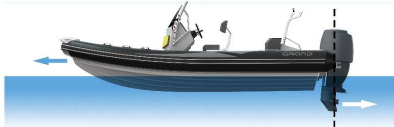
Fig. 22. Optimum trim/motor angle.
